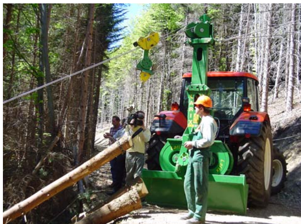
Démonstration de débardage par câble très utilisé dans les pays de l'Est
